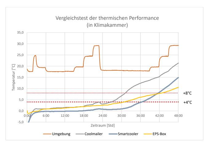
Klimakammertest unterschiedlicher Verpackungen mit je 1,5 Kg Kühlmittel (auf Wassereisbasis)
